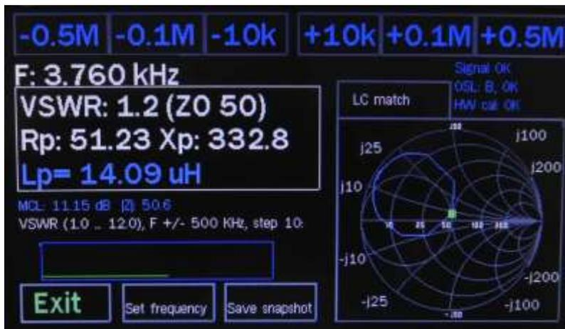
Das Antippen des **Smith Diagramms** zeigt die Dimensionierung der 2 möglichen LC Anpassnetzwerke, um die gemessene Impedanz auf 50 Ω zu transformieren:
